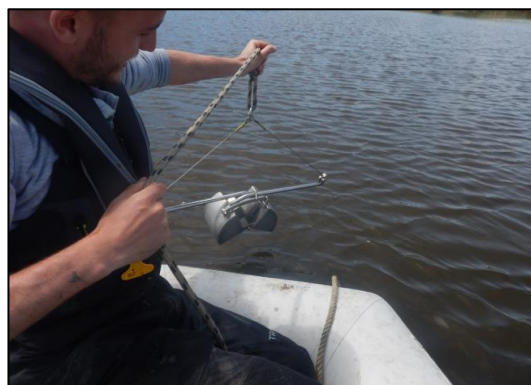
Figure 19 Localisation des points de prélèvements (à gauche) et aperçu de la benne Van Veen (à droite)
